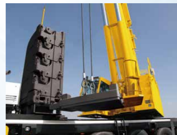
▲カウンタウエイトの組み方例(サイドベースの着脱)
